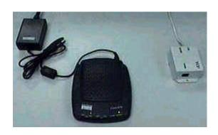
3.拿出中華電信配給我們的 RJ-11 線,將 RJ-11 線插在 Splitter的 Modem 孔,及 ATU-R 的 WALL 孔上。
