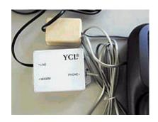
3.然後將 Splitter 的 Modem 端利用電話線接至 ADSL Modem 的 ADSL 端
