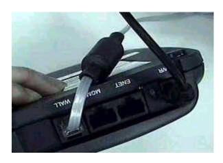
4.最後拿出 RJ-45, 並將此線分別插在 ATU-R 的 ENET 孔及我們的乙太網路卡上 (可用 10/100M)。
